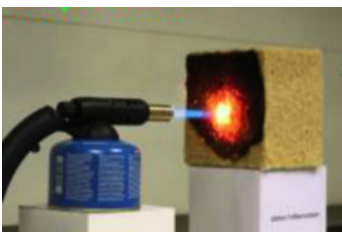
Träfiberisolering i form av skivor; reaktion vid inverkan av en enkel flamma, förkolning och smältning.
